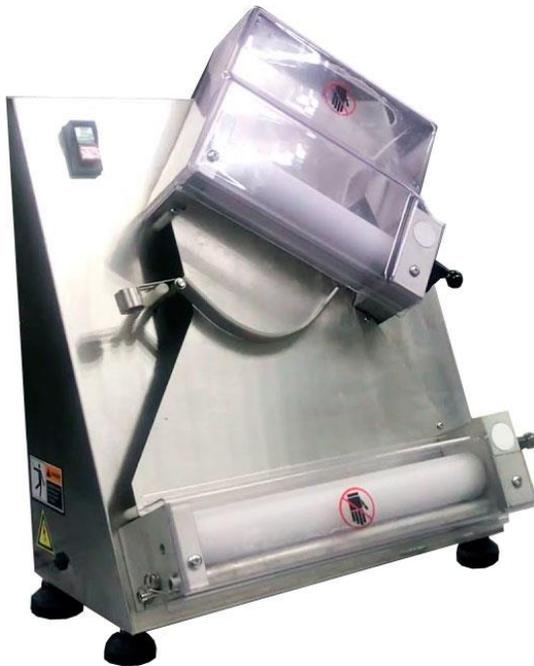
La formadora de pizza U-DL30 está ideada para laminar pasta y masa en frío utilizada en la preparación de pizzas, pan, pasta, hogazas, tortas obteniendo espesores y diámetros deseados. Posee dos parejas de rodillos regulables para obtener el espesor y forma circular requerida.
