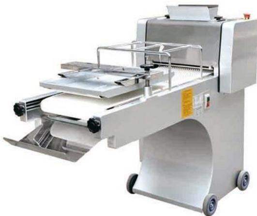
La formadora Unique U-FP38 tiene una capacidad de hasta 2000 piezas, en un rango de 50 a 600 gr. Posee un rango de laminación entre 1 a 15 mm y su alimentación eléctrica es monofásica (220V), con una potencia de 0.75 kW.
