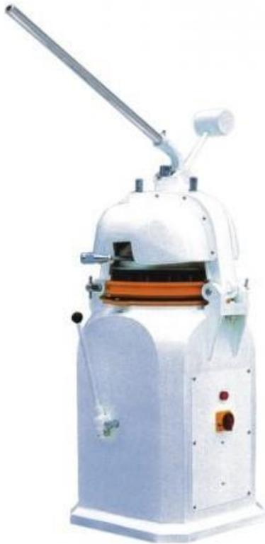
Permite cortar y ovillar 30 porciones iguales de masa de manera rápida, cómoda y efectiva. Gracias a su escasa mantención y rapidez de trabajo, este grupo permite optimizar la producción de panes, evitando mermas y homogeneizando la calidad del producto final.
