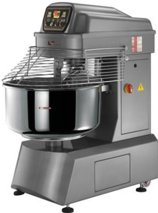
Amasadora de espiral con carro fijo de nueva generación construida bajo las más modernas técnicas de proyectación. Sus peculiaridades son: estructura en acero de grueso espesor, dos motores de doble velocidad con transmisiones por doble poleas, panel de mando electromecánico o digital con sonda de temperatura, protección artesera en ABS cerrada o con rejillas en acero inoxidable. Máquina montada sobre ruedas.
